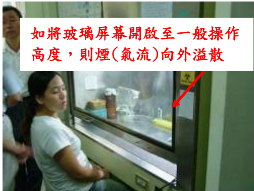
模擬實驗操作程序，並以”香”測試排氣櫃內氣流
