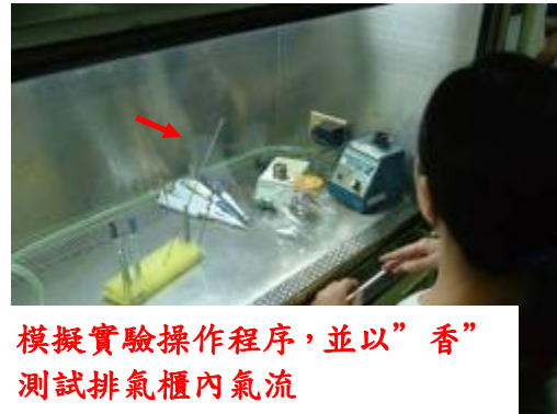
如將玻璃屏幕開啟至一般操作高度，則煙(氣流)向外溢散
