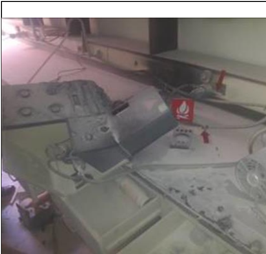
圖 1.經鑑識疑似起火點(此點為瓦斯管脫落可能氣體洩漏點)
