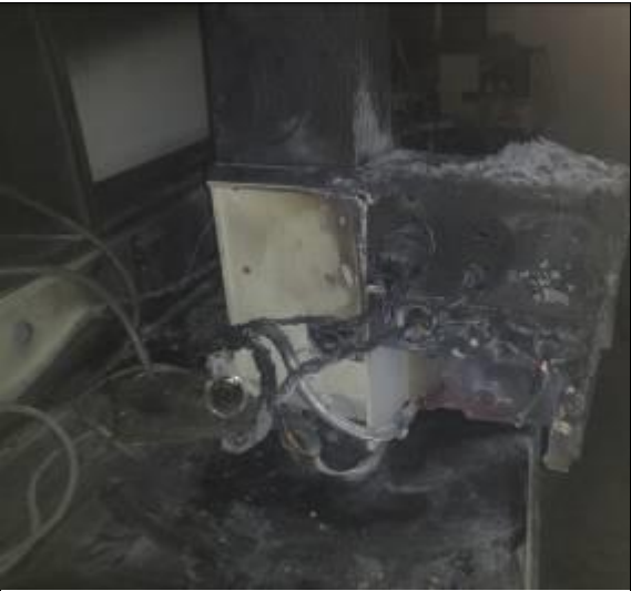
圖 6. 損毀之火焰光度計背面(疑似熱源點燃瓦斯後爆出點)
