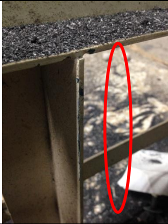
5-角鐵框架左側碰撞擦痕
