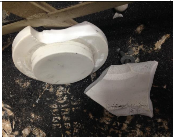
7-球磨鉢蓋及鉢體上方破裂碎片
