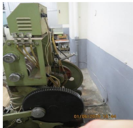
圖 2.發生災害之燙金機，紙片掉落後 方空間
