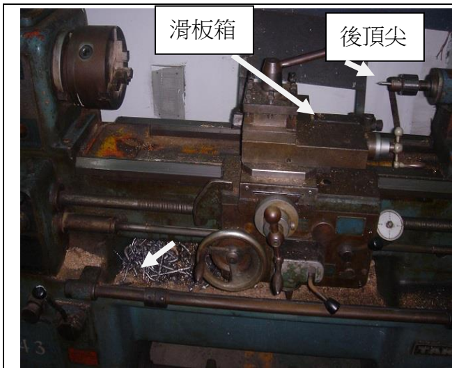
圖 1.肇災之臥式車床(滑板箱及尾座之後頂尖)
