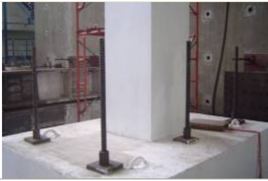
預力鋼棒突出段應加護套
