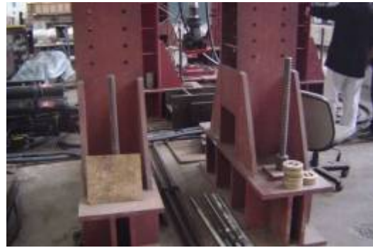
預力鋼棒突出段應加護套
