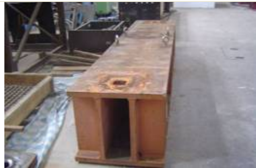
鋼樑撞擊地面造成凹損
